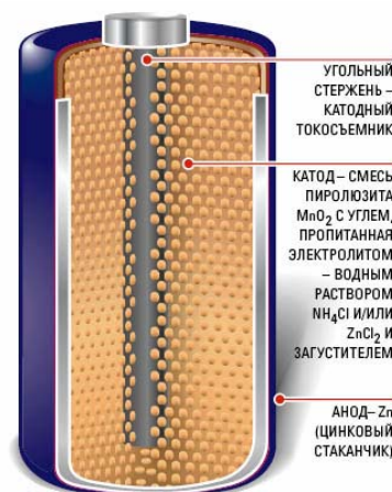
Рис. 1.81. Химический алкалайновый элемент]
